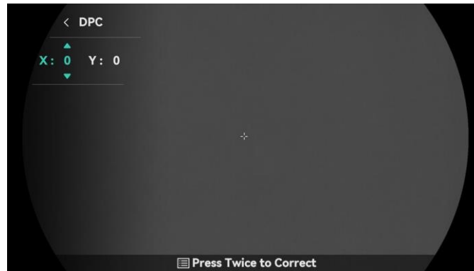
Rysunek 3-6 Korekcja wadliwych pikseli
